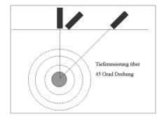
Nun wird die Antenne seitlich von der Leitungstrasse so lange weggezogen bis ein
